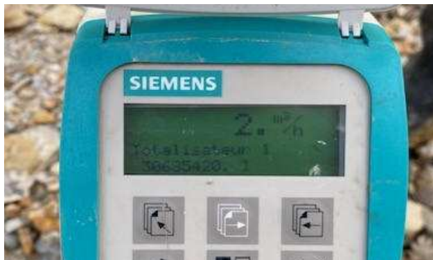
Compteur électronique affichant : 30 685,420 M3 et 2 M3/H
